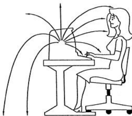
شکل ۴۱- خطوط میدان الکتریکی ناشی از نمایشگر عمود بر سطح بدن کاربر
