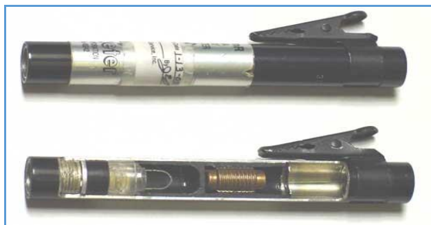
شکل ۸۹- دزیمتر جیبی نوع قرائت شونده Self-Reading
