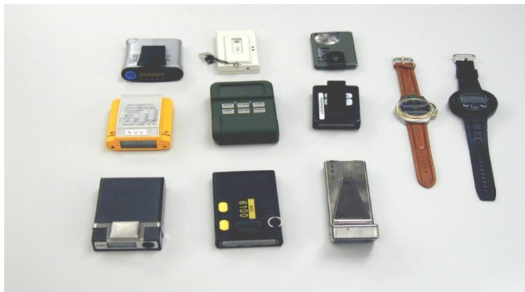
شکل ۸۳- دزیمترهای الکترونیکی قرائت مستقیم بر مبنای آشکارساز نیمه‌هادی
