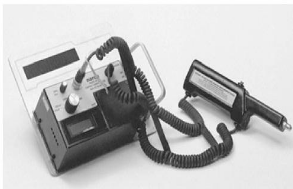
شکل ۳۹- دستگاه اندازه‌گیری شدت جریان تماسی
