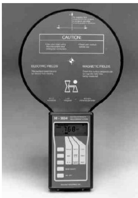
شکل ۴۹- دستگاه مدل HI- 3604 جهت اندازه‌گیری در محدوده ELF
