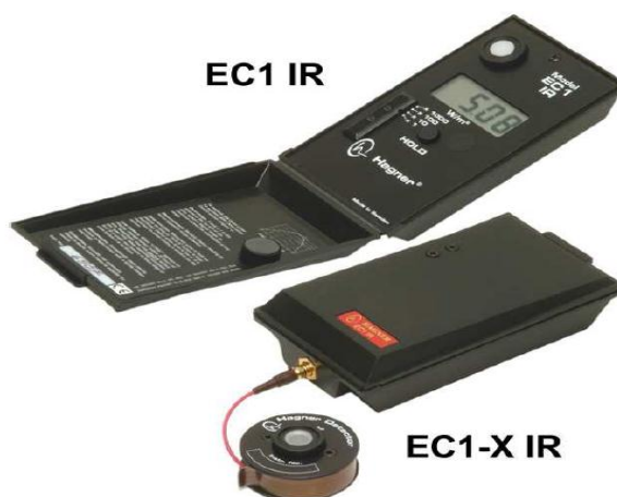
شکل ۲۴ - نمونه رادیومتر اندازه‌گیری پرتو مادون قرمز نزدیک
