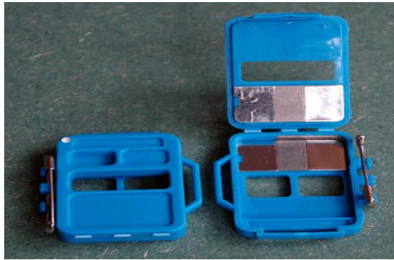
شکل ۸۶- محل جانمایی فیلم و فیلترهای فلزی داخل فیلم بچ
